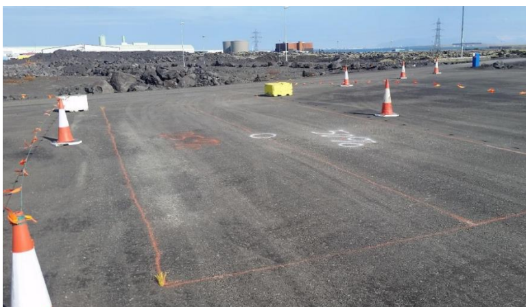
Mynd 1: Tilraunasvæði með mis mikla íblöndun malbikskurls. Gert var plötupróf til að fá samanburð á burðarþoli.
