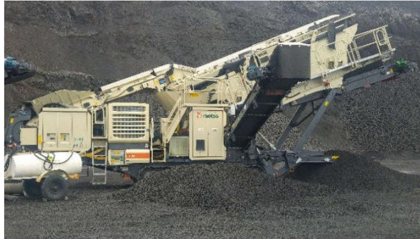
Mynd 4: Steypuafganagnar malaðir með kónbrjótí 6
