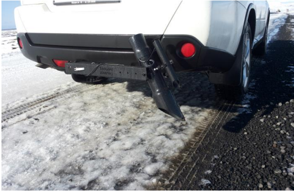
Mynd 11: RCM mælir frá Teconer. Notaður til að mæla veghita í verkefnum 2016 og 2017
