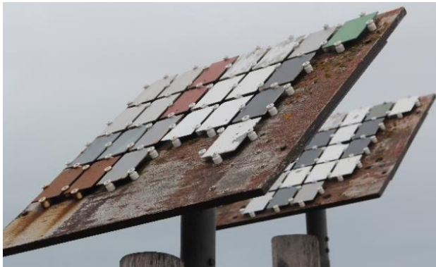
Mynd 5: Rekki með sýnum til mælinga á tæringu stáls
